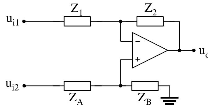
Izborom ulaznog kraja i impedansi u kolu moguće je realizovati filtre propusnike niskih i visokih frekvencija prvog reda. Izlazni napon je u opšem slučaju dat sledećim izrazom:
